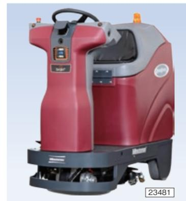
20インチ自動床洗浄機ロボット
