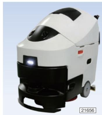
自律走行式 ロボット床面洗浄機
